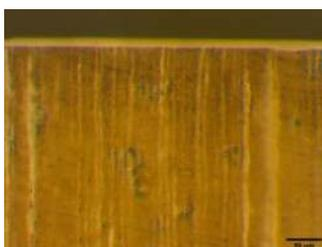
Fig.1 Micrografía óptica capa nitrurada 200x
