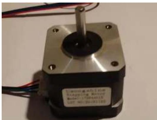
Fig. 1. Motor Nema 17 “Usongshine”
