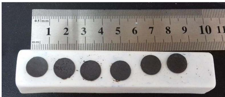
Figura 1. Pastillas de LSGM prensadas y tratadas térmicamente.
