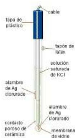
Fig. 1. Electrodo combinado de pH de Ag/AgCl. [2]
