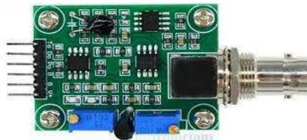
Fig. 3. Módulo de adaptación de señal PH-4502C. [4]
