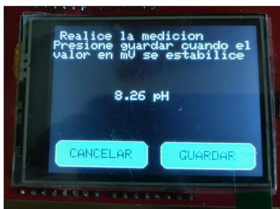
Fig. 6. Pantalla de medición durante la calibración.
