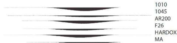
Figura 8: Perfilograma de huellas de erosión
