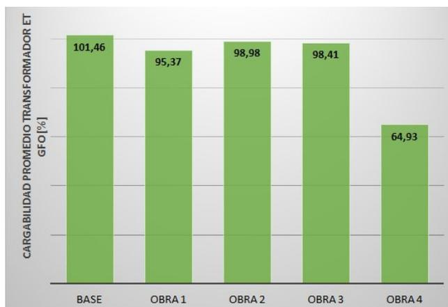
Figura 11. Cargabilidad promedio del transformador 500/132 kV 132 kV para caso Base y alternativas de obra. Escenario de demanda pico de Año 1
