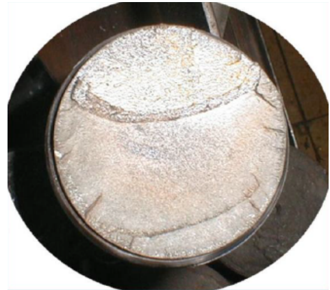
Figura 1. Ruptura por fatiga
